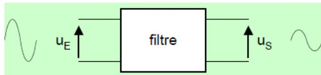
Un filtre est un circuit linéaire qui modifie l'amplitude du signal et non pas sa fréquence.
