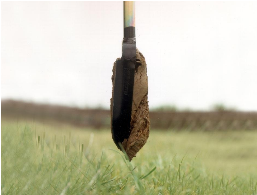
Figure 2 : Tarière de prélèvement du sol
