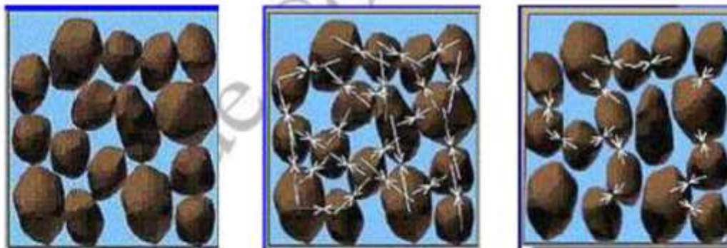
a) avant la liquéfaction ; b) quand la pression interstitielle augmente ; c) pendant la liquéfaction
