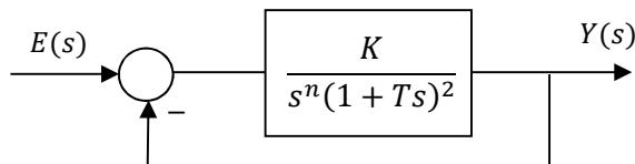
Détermination des paramètres  $K$ ,  $n$  et  $T$  pour que le système en BF satisfait les exigences suivantes: Erreur en vitesse  $e_v = \frac{1}{50}$ , et La marge de gain  $\Delta G = 6 \text{ dB}$ .
