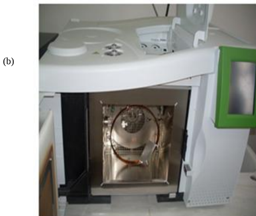
Fig.1 (a)et (b) schéma et photo d'un appareil de chromatographie gaz
