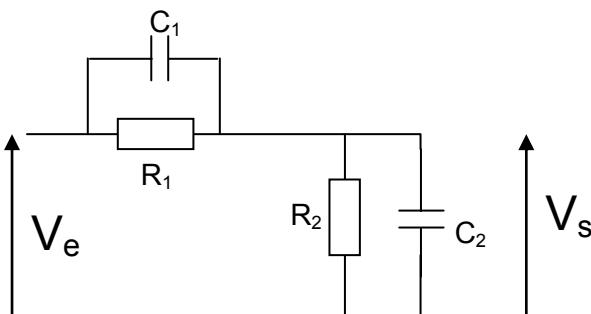
On considère le montage de la figure suivante : On se place en régime harmonique. Déterminer de deux manières différentes le rapport  $V_s/V_e$  (gain en complexe).
