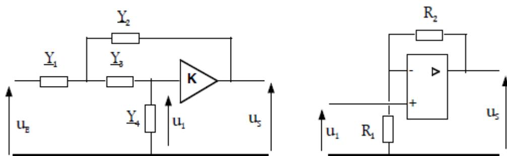
L'amplificateur de tension de gain K est réalisé par le montage de la figure de droite;
