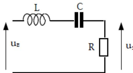
$$T(jx) = \frac{2\xi (jx)}{1 + 2\xi jx + (jx)^2} \text{ avec } x = \frac{\omega}{\omega_0} \text{ et } \omega_0 = \frac{1}{\sqrt{LC}} \text{ et } \xi = \frac{R}{2} \sqrt{\frac{C}{L}}$$
