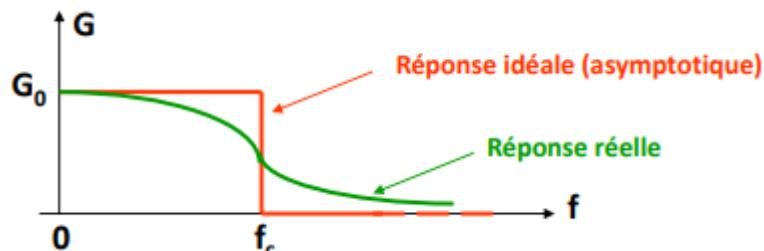
Ce filtre ne laisse passer que les basses fréquences du signal d'entrée. Les hautes fréquences sont donc filtrées. La limite entre BF et HF est appelée fréquence de coupure  $f_c$ . La bande passante est la gamme de fréquence non filtrée :  $BP = [0, f_c]$
