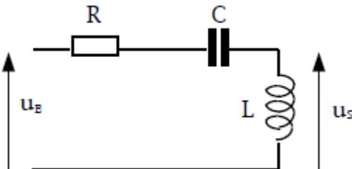
$$T(jx) = \frac{(jx)^2}{1 + 2\xi jx + (jx)^2} \text{ avec } x = \frac{\omega}{\omega_0} \text{ et } \omega_0 = \frac{1}{\sqrt{LC}} \text{ et } \xi = \frac{R}{2} \sqrt{\frac{C}{L}}$$
