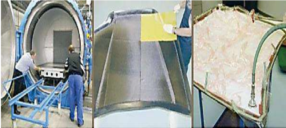
Fig.2.15:Equipements et outillages pour le moulage de pré-imprégnés
