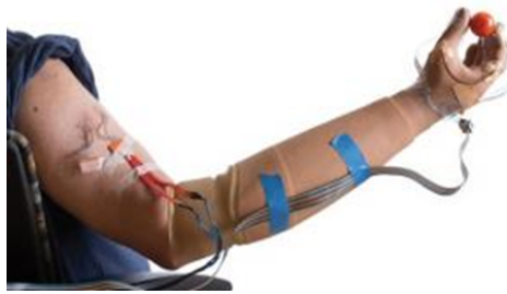
FIGURE 5.7 – Prothèse robotique avec retour de sensations, où le patient peut sentir le toucher de la prothèse.
