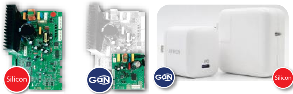
FIGURE 4.7 – Illustration de la différence entre un circuit en silicium et en nitrure de gallium (GaN) : le GaN permet des circuits plus petits et plus efficaces.
