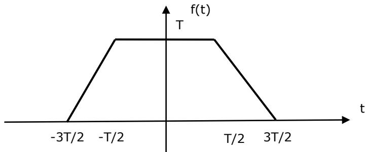
$$f(t) = \begin{cases} 0 & \text{si } t < \frac{-3T}{2} \\ t + \frac{3T}{2} & \text{si } \frac{-3T}{2} < t < \frac{-T}{2} \\ T & \text{si } \frac{-T}{2} < t < \frac{T}{2} \\ -t + \frac{3T}{2} & \text{si } \frac{T}{2} < t < \frac{3T}{2} \\ 0 & \text{si } t > \frac{3T}{2} \end{cases}$$
