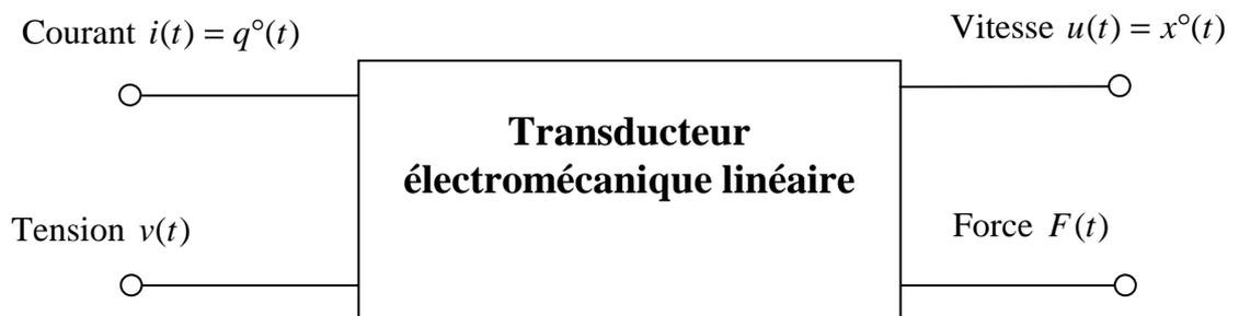
**Figure 4.2.** Un transducteur électromécanique représenté comme quadripôle
